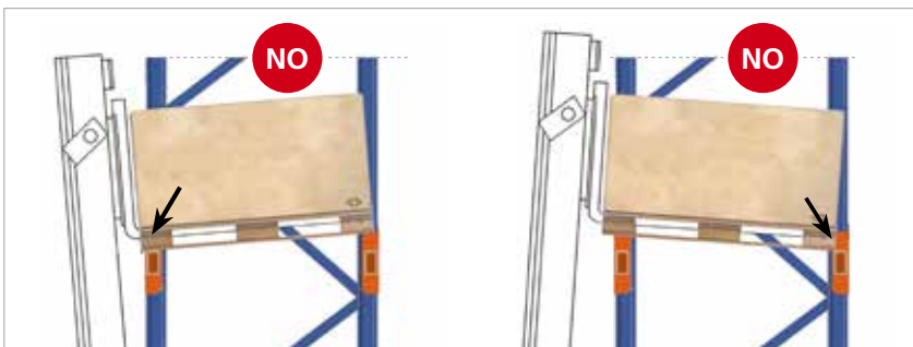
Figura 9. Sobrecarga sobre un larguero por descenso no horizontal.
