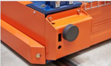
**Barreras internas.** Detectan la presencia de objetos en el pasillo que impedirían el correcto funcionamiento del sistema.
