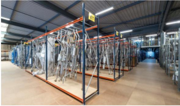
Los productos voluminosos se depositan en las estanterías idóneas para facilitar su manejo. Por ejemplo, los tubos de escape se colocan colgados en estanterías y algunas de sus partes se hallan sobre estantes de madera.
