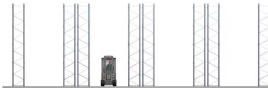
Sistema convencional más común formado por un rack sencillo adosado a la pared y racks dobles centrales
