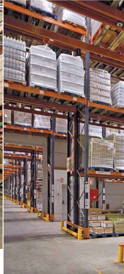
Depósito de racks selectivos con pallets manipulados por el lado de 800 mm
